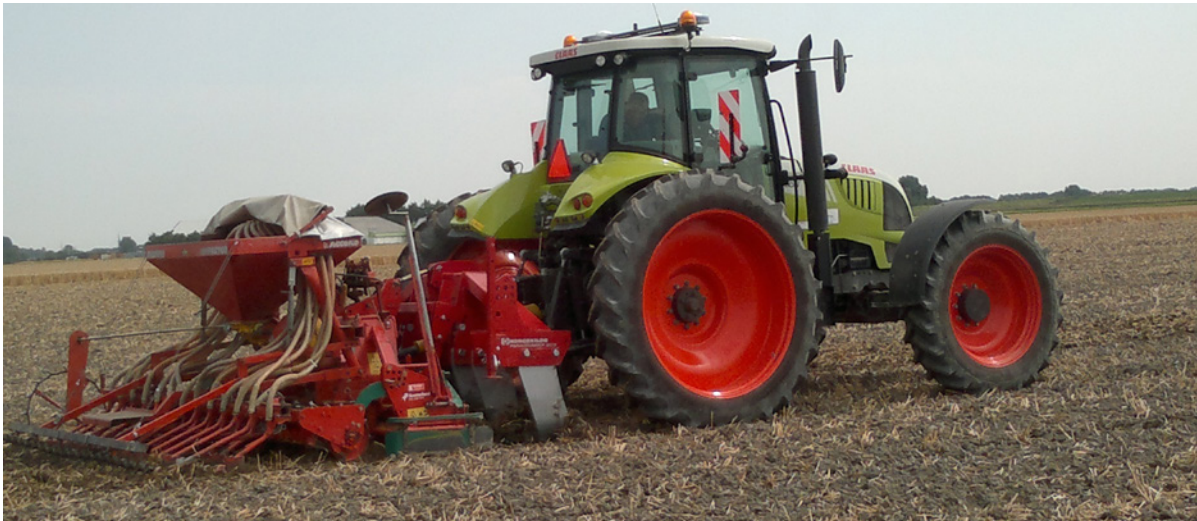
Figuur 2. Een voorbeeld van niet-kerende grondbewerking: Woelen, kopeggen en zaaien in één werkgang op vaste rijpaden.
