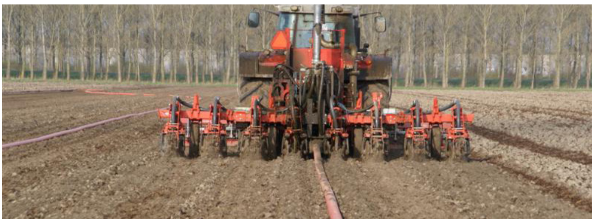
Figuur 2: Rijenbemesting met dierlijke mest in een aparte werkgang met vastleggen RTK-GPS AB-lijn voor sturing van de trekker
