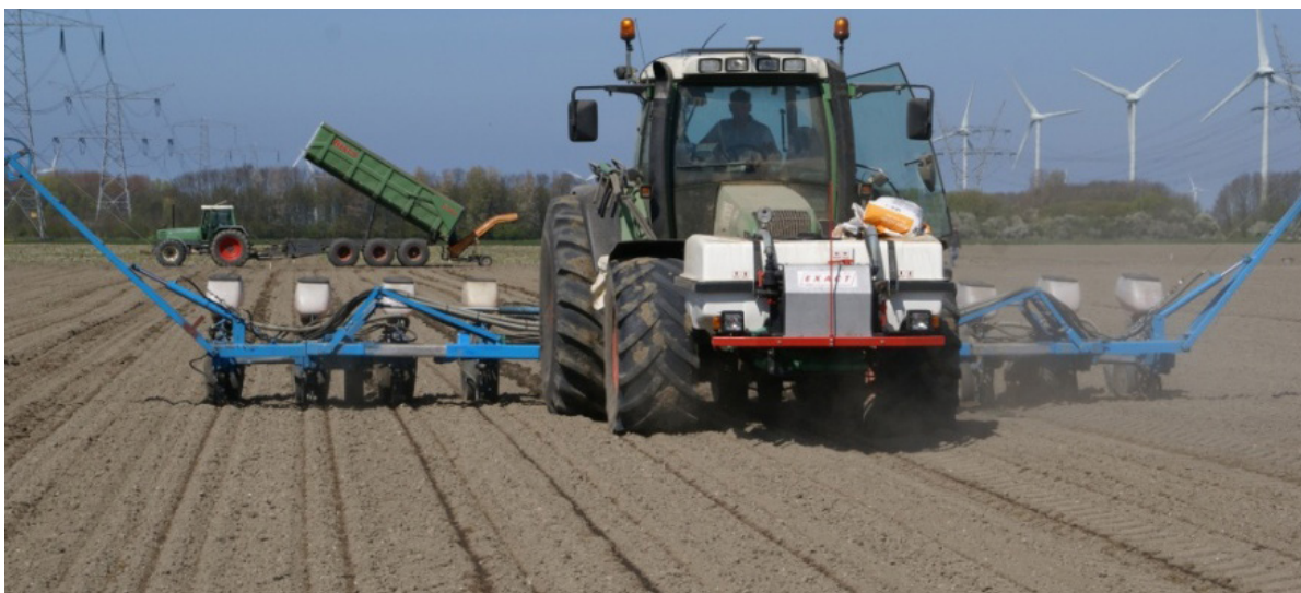
Figuur 3: Met de zaaimachine en trekker met RTK-GPS automatische sturing wordt het zaad precies midden op de geïnjecteerde mest gezaaid.
